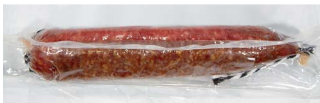
Imagen 9a. Oxidación debida a un material baja barrera al oxígeno.
