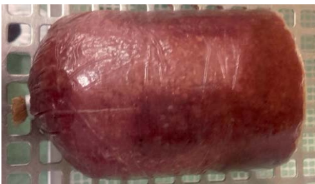
Imagen 2k. Defecto ocasionado durante el clipado.
