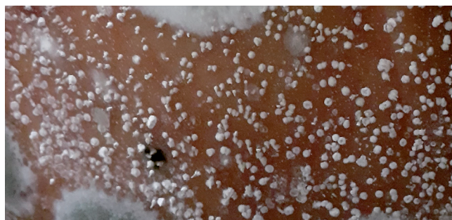
Imagen 39b. Precipitado de fosfato en la piel a HR muy elevada.
