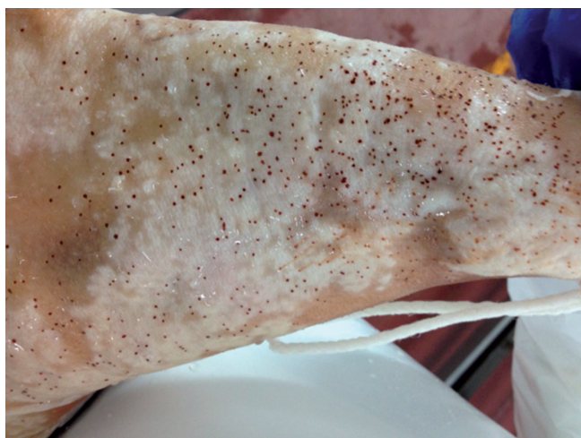
Imagen 43d. Crecimiento de microorganismos halófilos sobre la piel hidratada y con alto contenido en sal.
