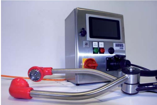
Aturdidores eléctricos con registro de datos adaptado a las últimas normas.
