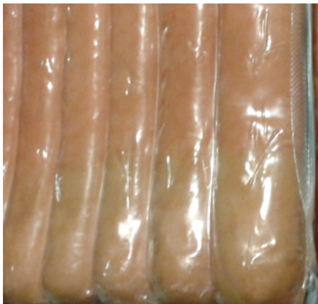
Imagen 15d. Decoloración superficial de salchichas debido a la entrada de oxígeno en la zona lateral que sufrió mayor estiramiento en el termoformado y que estuvo expuesta a la luz.
