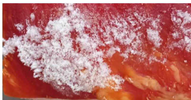
Imagen 24d. Precipitado de \text{Na}_2\text{HPO}_4 .
