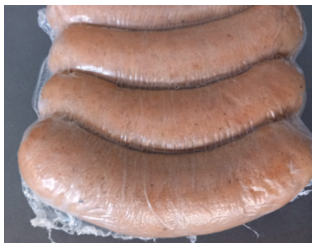
Imagen 34c. Deformación del envase debido a un tratamiento térmico excesivo para el material de envasado.
